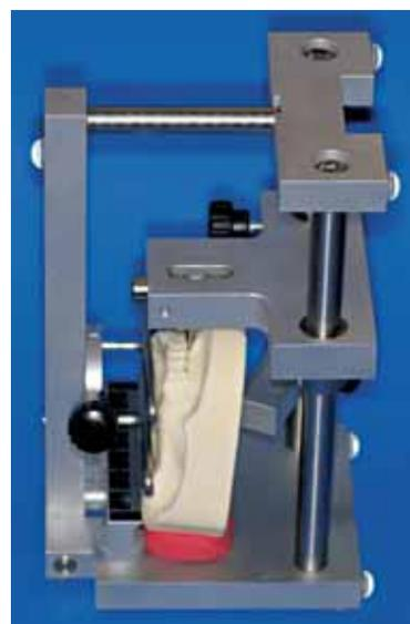
Abb. 23 Adaptieren der Bügel des Adapters des Einbaustativs Ortho 2A an das Modell.
