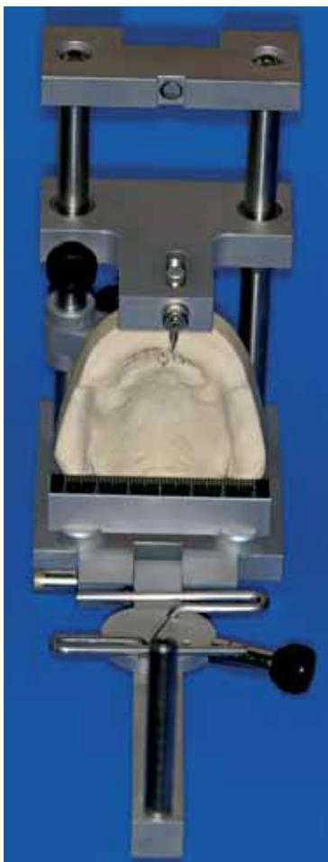
Abb. 21 Fixierung des Oberkiefermodells im Positionierer Ortho 1A mittels Plastilina, Ausrichtung der Medianen am Nullpunkt der Messskala und Positionierung der Messspitze auf die Conclusionslinie.
