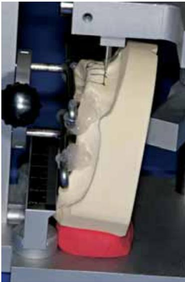
Abb.24 Fixierung des Modells mittels Heissklebstoff auf dem Adapter des Einbaustativs Ortho 2A.
